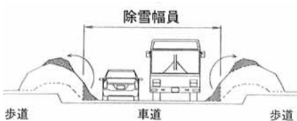
積上げ除雪、カット排雪などで道路幅を確保する。
