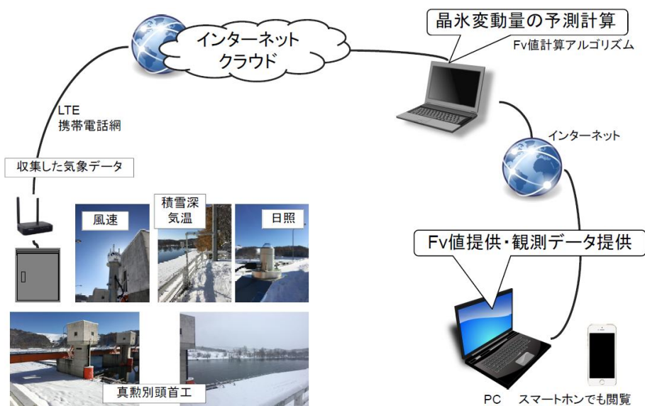
図3 アイスクラム発生予測システム概念図
