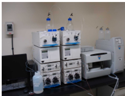
イオンクロマトグラフポストカラム分析計 (シアン及び臭素酸を検査します)
