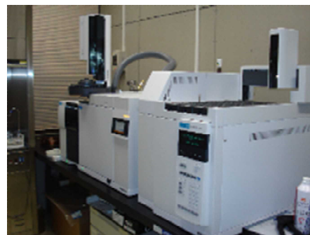
ガスクロマトグラフ質量分析計 (消毒副生成物などを検査します)
