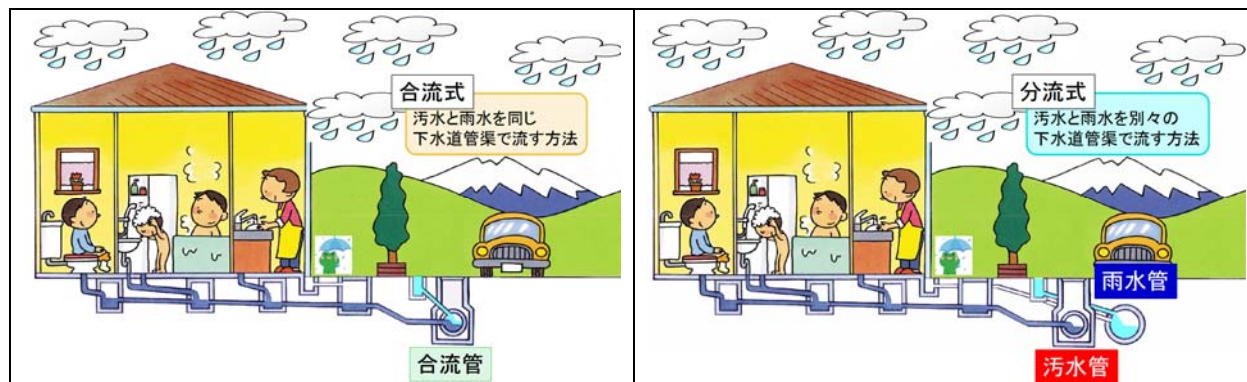
図 0.1 合流式下水道と分流式下水道イメージ図
